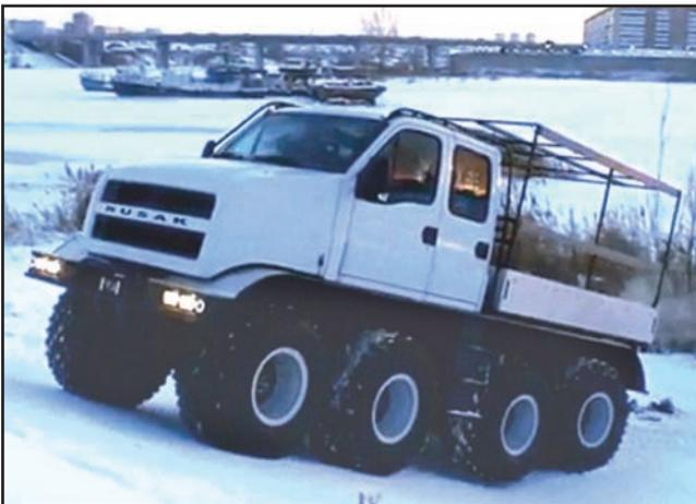
Дизайн вездехода разработал Ильгиз Хамаев. Предполагается, что если машина пойдёт в серию, то будут использоваться более дешёвые кабины от «ГАЗель Next» или кабину собственной разработки. Четырёхосный предназначен для тяжёлого бездорожья с минимальным давлением на грунт. Машина может быть востребована у нефтяников и геологов для перемещения по снегу и тундре. Как сообщает портал «Русский автомобиль», в данный момент проект ждёт инвесторов.
